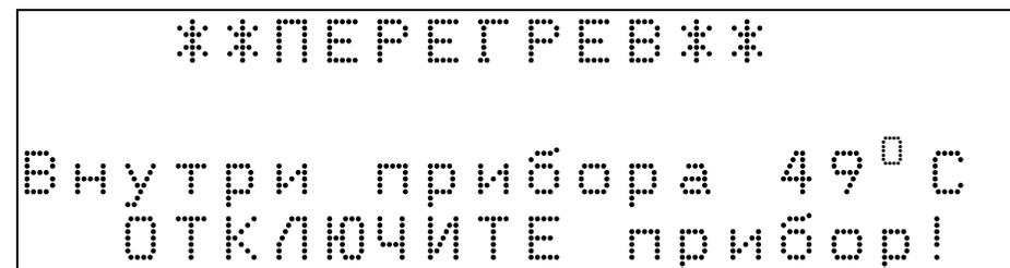
и ждет отключения (Прибор установлен на солнцепёке или температура окружающей среды > 40°C).
