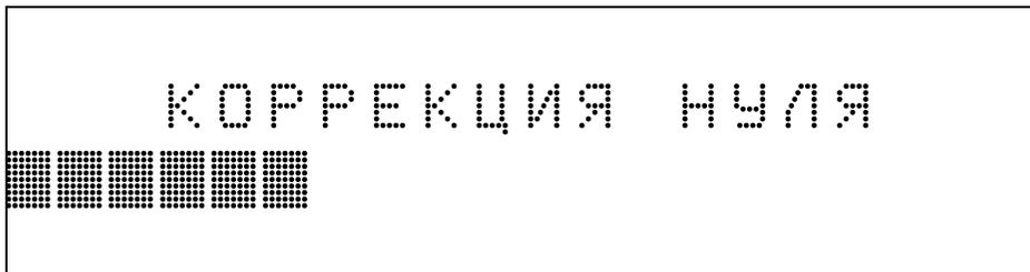
Примечание – При перегреве или переохлаждении (при резком изменении температуры окружающей среды) на 5 секунд выдается сообщение:
