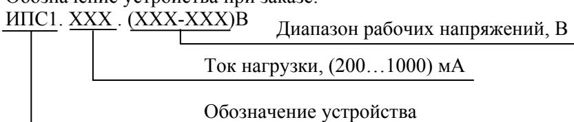
Пример обозначения ИПС1, с номинальным током нагрузки 700 мА, с диапазоном рабочих напряжений (60...130) В при заказе:
