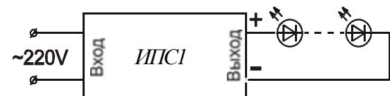
Рис.2 Схема включения
