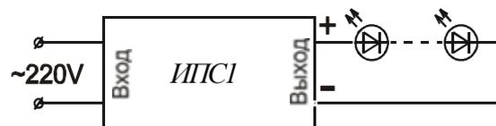
Рис.2 Схема включения ИПС1
