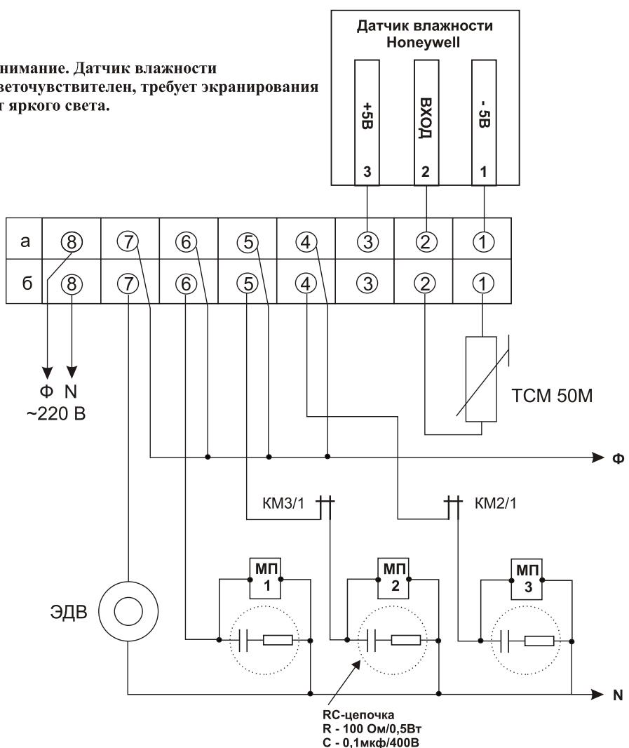
ЭДВ - однофазный электродвигатель (вытяжной вентилятор) от 10 до 100 Вт. Включается при превышении заданного значения влажности в камере.
