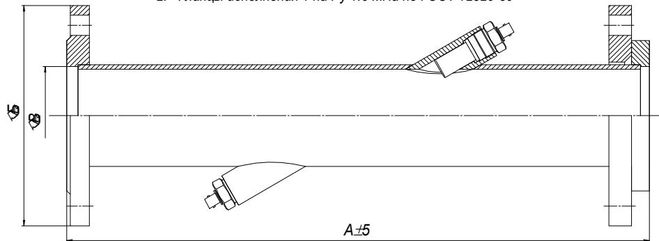
б) Расположение датчиков V-образно в диаметральном сечении.
