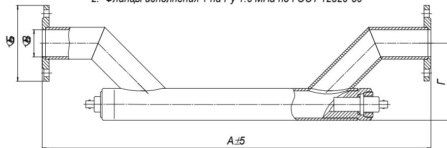
б) Литой Dy50 с расположением датчиков V-образно в диаметральном сечении.
