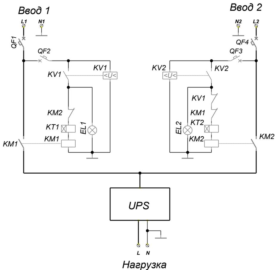
KM1, KM2 - силовые контакторы (магнитные пускатели)
