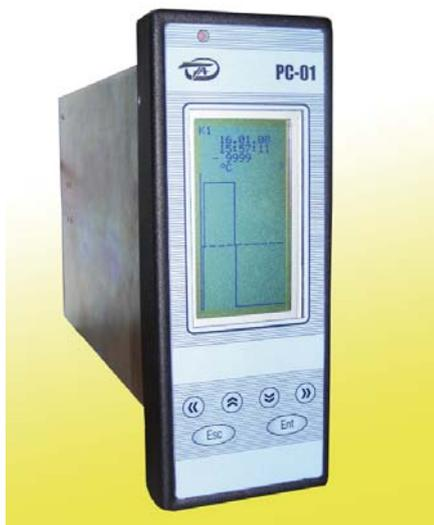
Регистратор предназначен для измерения и регистрации во внутренней энергонезависимой памяти входных аналоговых сигналов от термоэлектрических преобразователей (термопар), термопреобразователей сопротивления, а также нормированных сигналов постоянного тока и напряжения по одному или двум каналам. Тип входного сигнала для каждого канала выбирается и устанавливается потребителем программно на этапе ввода прибора в эксплуатацию или в процессе эксплуатации.
