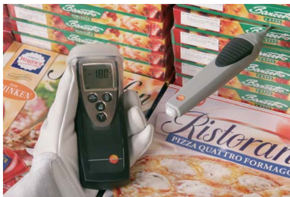
Проверка поступивших товаров, отсутствие раздражающих кабелей благодаря радио зондам*
