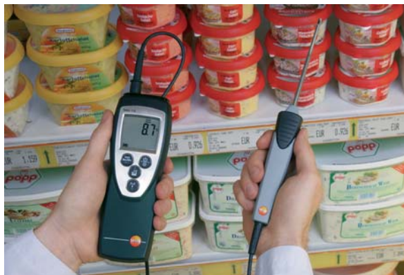
Инспекция работы холодильных прилавков на наличие достаточной холодильной мощности
