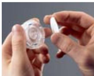
Фильтр должен удалять твердые частицы из газовой пробы. Поэтому фильтр расположен в рукоятке зонда, где к нему обеспечен удобный доступ. Запатентованная Testo технология проведения измерений гарантирует надежные измерения даже при
