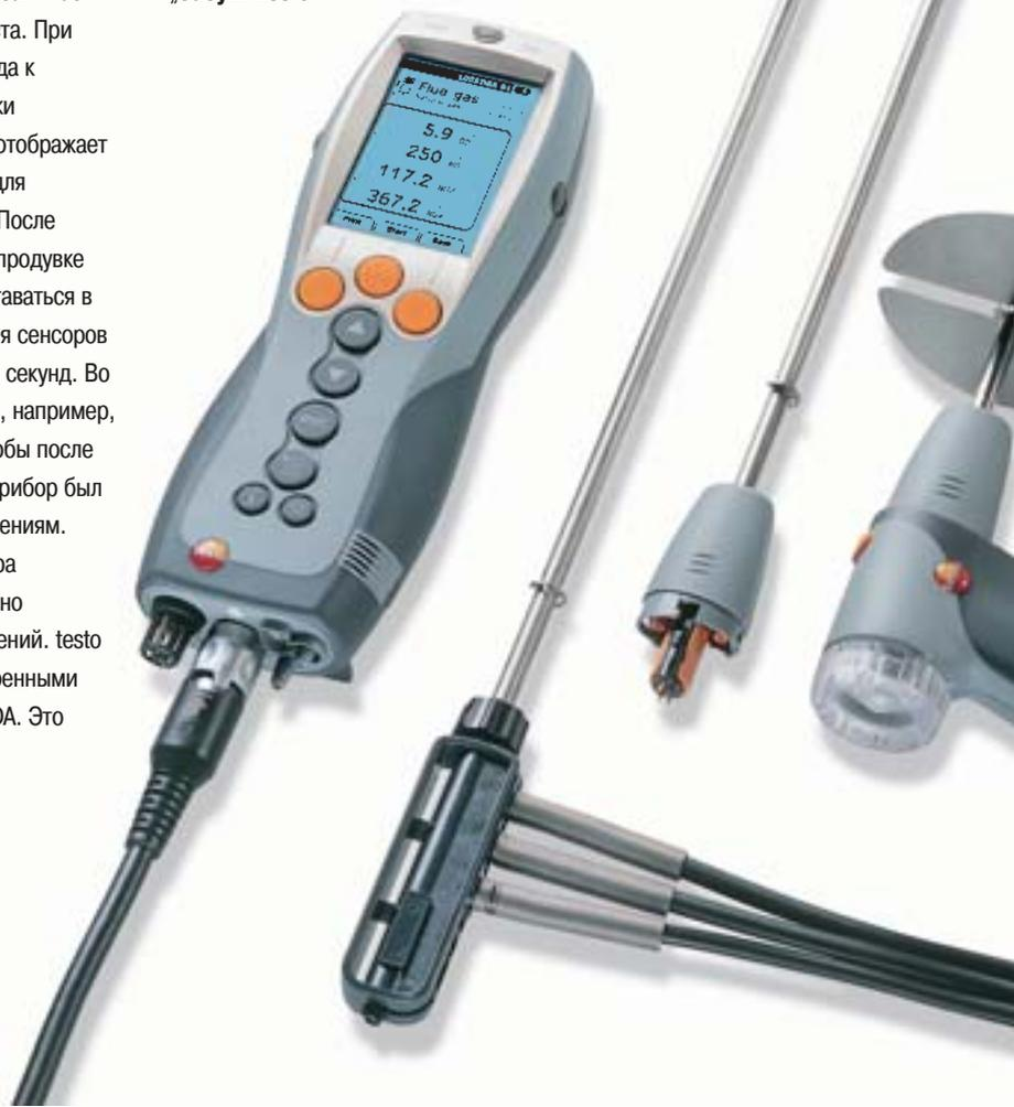
Зонд с предварительным фильтром на наконечнике для анализа запыленных газов
