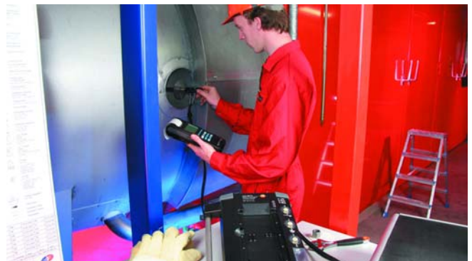
testo 350 XL: Контрольные измерения на турбинах (O 2 , CO низ , NO низ , NO 2 )
