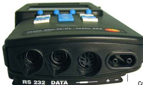
соединение с шиной данных Testo Подключение дополнительных зондов Соединение для измерения дифференциального давления/скорости потока
