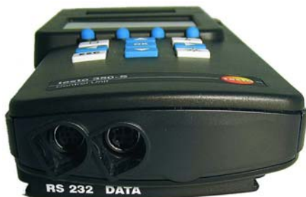
соединение с шиной данных Testo Соединение RS232
