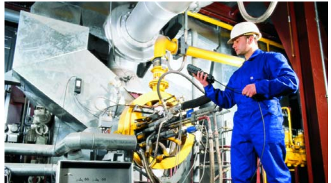
testo 350 XL: Стандартный комплект измерения параметров технологических процессов (O 2 , CO, NO, NO 2 )
