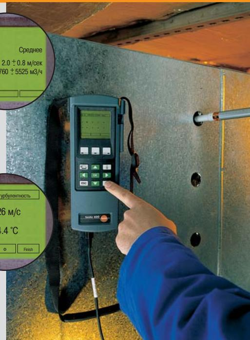
Координаты необходимые для измерений отображаются на дисплее. Данные о глубине погружения в воздухоход телескопической крыльчатки существенно облегчают работу.
