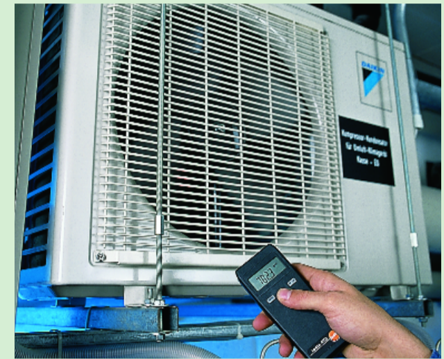
Измерения в недоступных местах с testo 465
