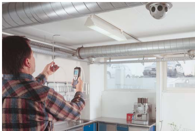
Измерения скорости воздуха в воздуховодах
