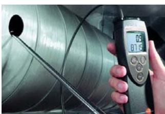
**Термоанемометр testo 425 и анемометры с крыльчаткой testo 416, testo 417**
