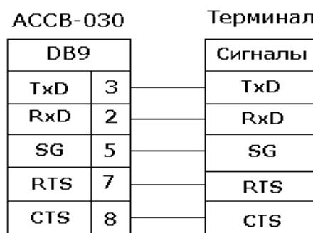
Второй вариант предназначен для подключения к компьютеру в качестве универсального модема. Используется драйвер **Стандартного модема 19200** из состава операционной системы Windows. Здесь переключатель SK2.П2 ставится в положение OFF, а SK2.П3 – в положение ON. Соединения выполняются по следующей схеме:
