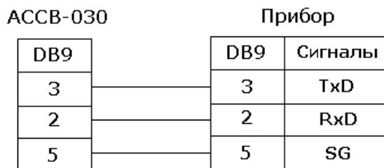
При этом в настройках приборного интерфейса следует выбирать прямое подключение без управления потоком.
