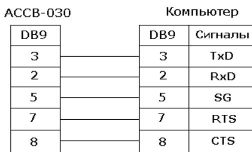
Для подключения может использоваться стандартный модемный кабель. Он содержит еще четыре проводника, которые в данном случае не используются.
