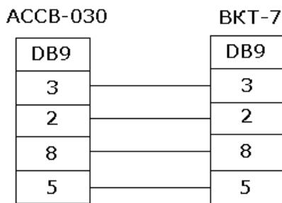
Прибор КМ-5 подключается к АССВ-030 через переходник АПИ-5. Переходник выпускается производителем КМ-5. Он представляет собой двусторонний разъем DB-9. Сторона переходника, обращенная к внешнему оборудованию, подключается к АССВ-030 в соответствии со схемой, приведенной для прибора ВКТ-7.
