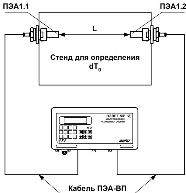
**Рис. И.1. Определение смещения  $dT_0$  с помощью стендa.**
