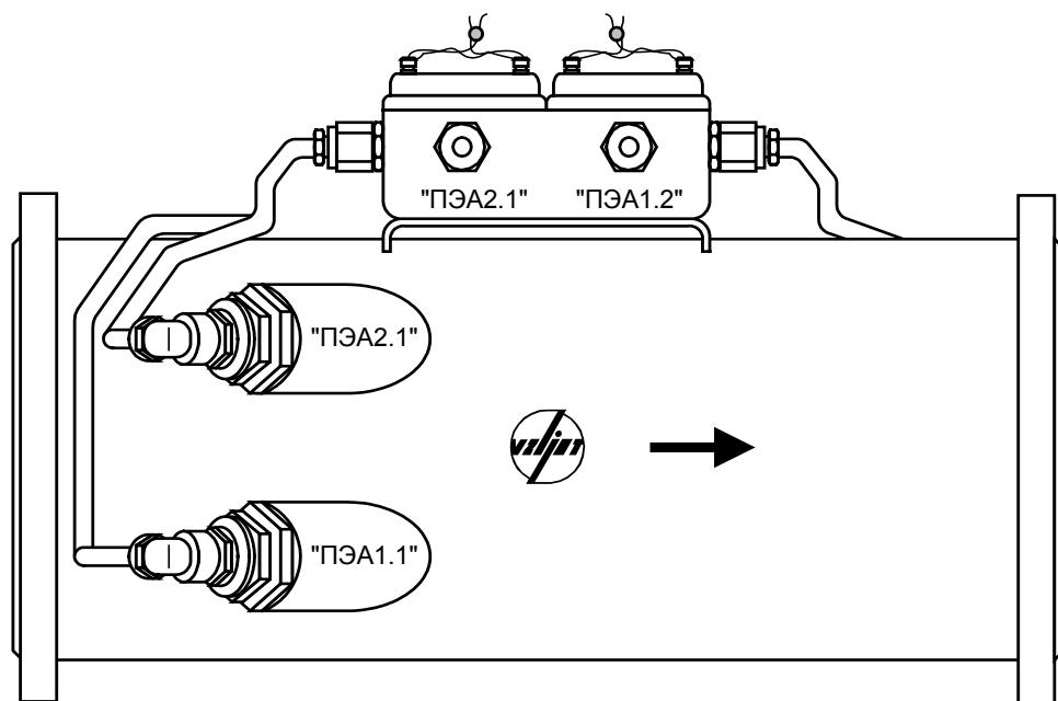
1 – измерительный участок; 2 – блок коммутации; 3 – ввод для кабеля связи с ВП; 4 – патрубок для установки врезного ПЭА; 5 – врезной ПЭА; 6 – вывод ПЭА в медной трубке.
