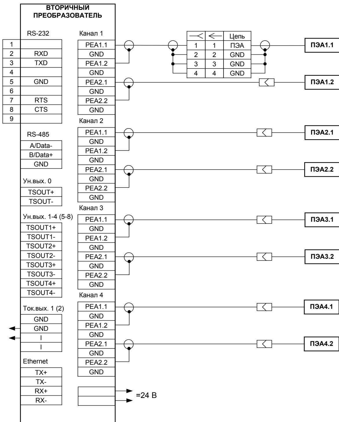
Рис.Б.1. Схема соединений расходомеров исполнений УРСВ-54x ц.
