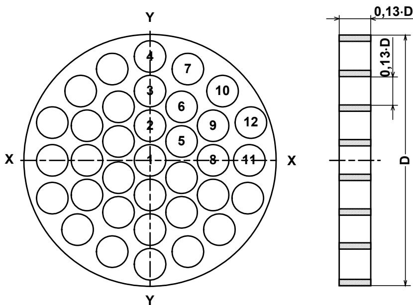
*D – внутренний диаметр трубопровода, в который устанавливается струевыпрямитель.*
