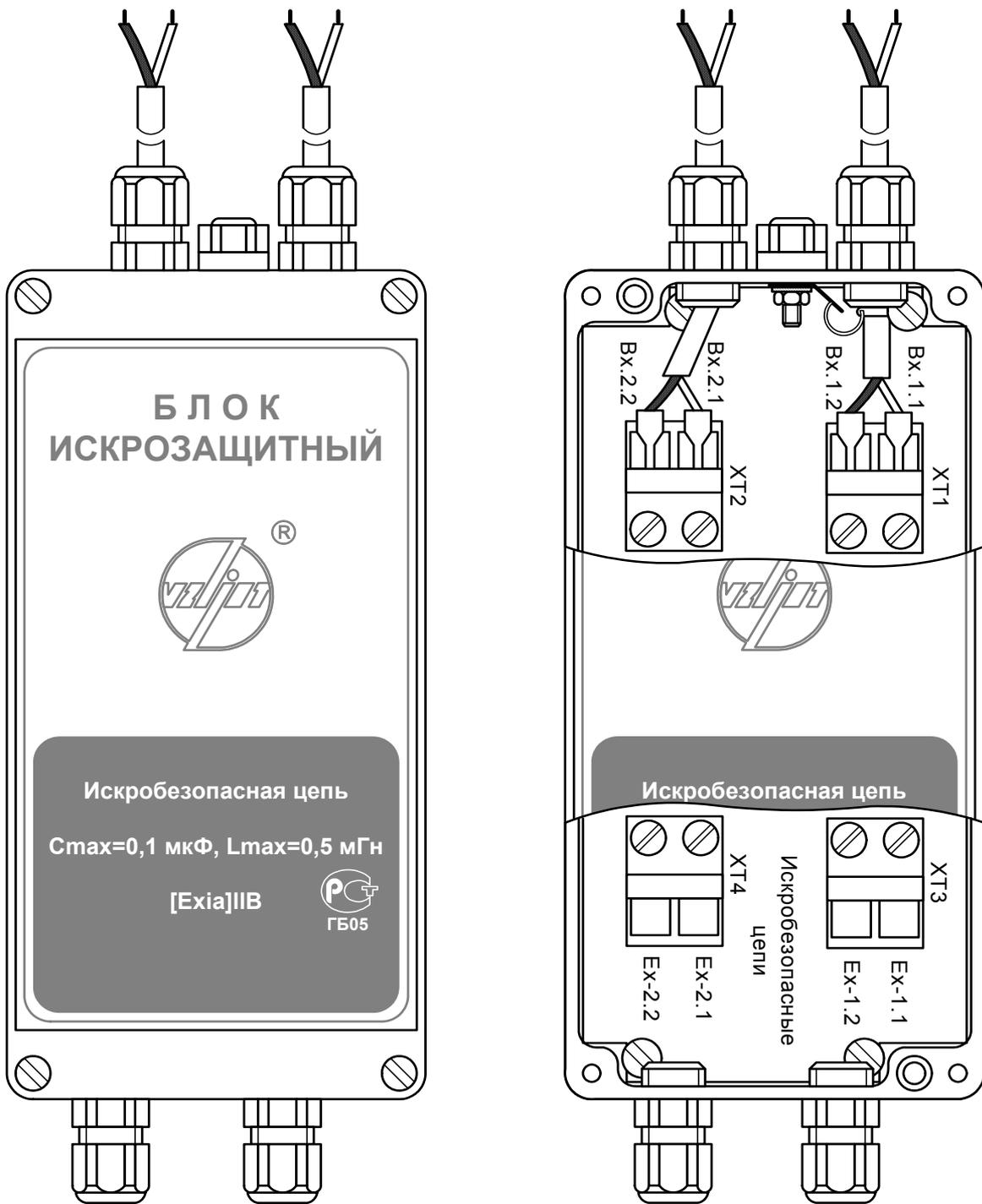
Рис. 4. Вид блока искрозащитного.
