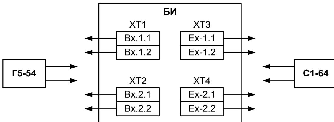
**Рис. 5. Схема проверки уровня ограничения выходного сигнала.**
