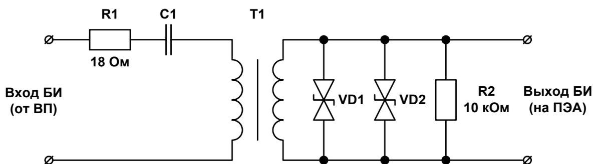
Рис. 3. Схема канала искрозащиты.
