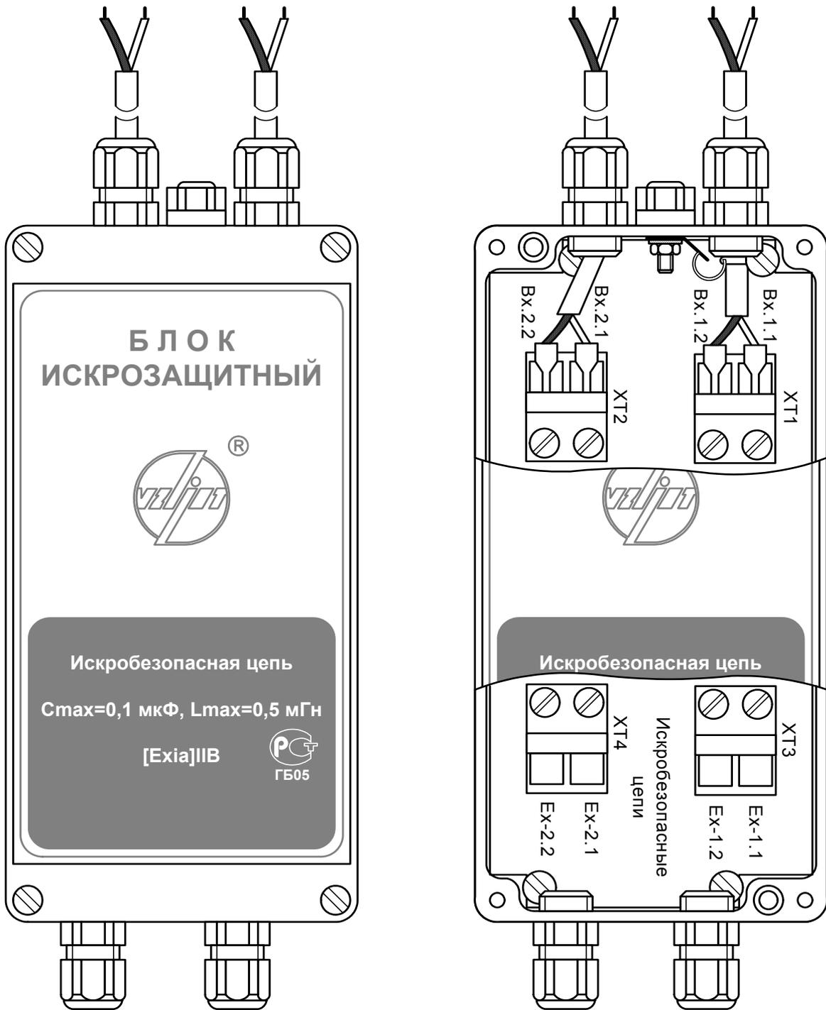
Рис. 4. Вид блока искрозащитного.
