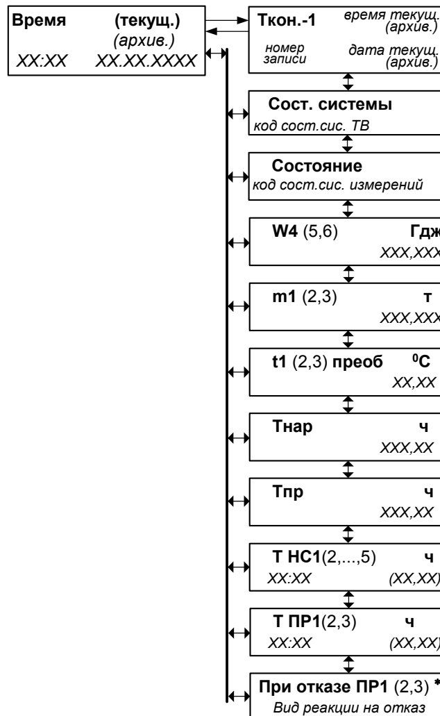
Рис.3. Структура окон индикации буферного накопителя (архивной записи).
