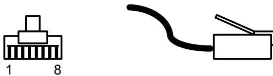
а) вид и нумерация контактов разъема RJ45
