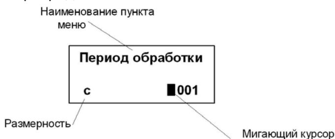
**Рис. 3. Пример установки периода обработки в подменю Накопление меню УСТ.**
