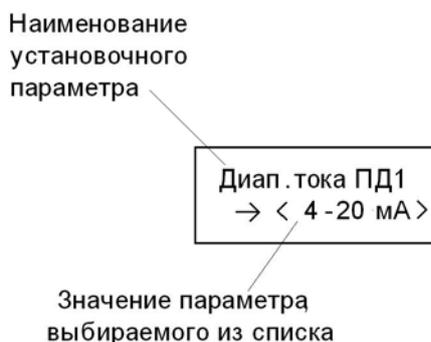
**Рис. 4. Пример установки диапазона первого входа измерения давления корректора в подменю Давление меню УСТ.**
