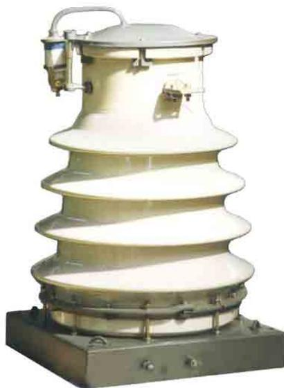
С обмоткой звеньев типа, бумажно-масляной изоляцией предназначен для передачи сигнала измерительной информации приборам измерения, защиты, автоматики, сигнализации и управления в электрических цепях переменного тока частоты 50 или 60 Гц.
