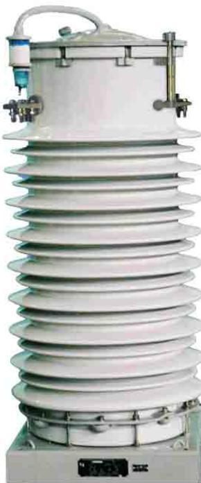
С обмоткой звеньевого типа, бумажно-масляной изоляцией предназначен для передачи сигнала измерительной информации приборам измерения, защиты, автоматики, сигнализации и управления в электрических цепях переменного тока частоты 50 или 60 Гц.
