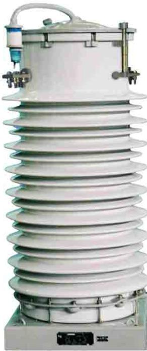
С обмоткой звеньев типа, бумажно-масляной изоляцией предназначен для передачи сигнала измерительной информации приборам измерения, защиты, автоматики, сигнализации и управления в электрических цепях переменного тока частоты 50 или 60 Гц.
