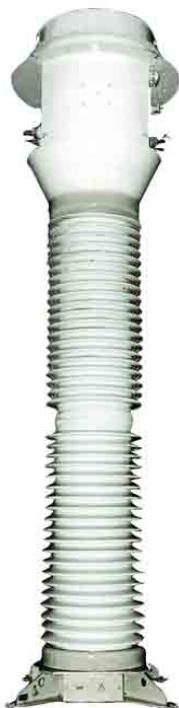
Герметичный, опорный, маслонаполненный с кабельно – конденсаторной изоляцией на вторичную обмотку и предназначен для передачи сигнала измерительной информации приборам измерения, защиты, автоматики, сигнализации и управления в электрических цепях переменного тока частоты 50 Гц
