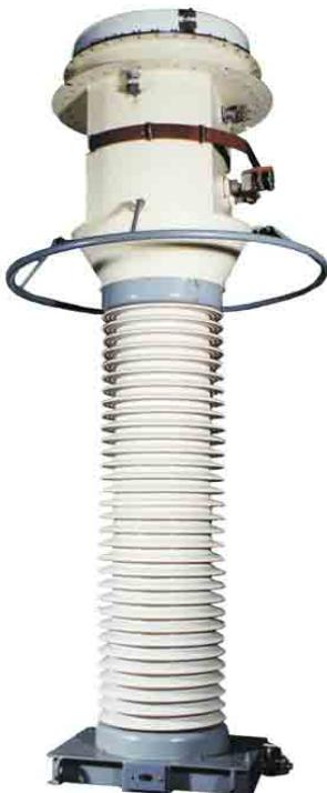
Герметичный, опорный, маслонаполненный с кабельно – конденсаторной изоляцией на вторичную обмотку и предназначен для передачи сигнала измерительной информации приборам измерения, защиты, автоматики, сигнализации и управления в электрических цепях переменного тока частоты 50 Гц.
