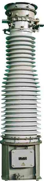
Герметичный, с кабельно – конденсаторной изоляцией, первичной обмоткой U – образной формы, предназначен для передачи сигнала измерительной информации, приборам измерения, защиты, автоматики, сигнализации, и управления в электрических цепях переменного тока.
