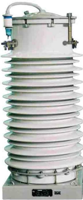
С обмоткой звеньевого типа, бумажно-масляной изоляцией предназначен для передачи сигнала измерительной информации приборам измерения, защиты, автоматики, сигнализации и управления в электрических цепях переменного тока частоты 50 или 60 Гц.
