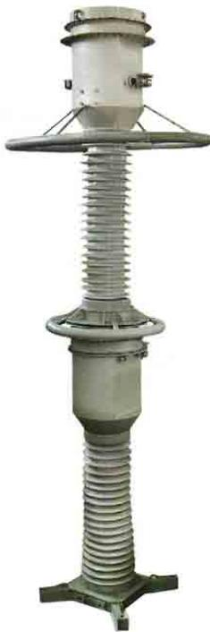
Герметичный, опорный, маслонаполненный с кабельно – конденсаторной изоляцией на вторичную обмотку и предназначен для передачи сигнала измерительной информации приборам измерения, защиты, автоматики, сигнализации и управления в электрических цепях переменного тока частоты 50 Гц
