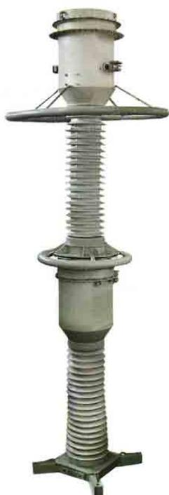
Герметичный, опорный, маслonaполненный с кабельно – конденсаторной изоляцией на вторичную обмотку и предназначен для передачи сигнала измерительной информации приборам измерения, защиты, автоматики, сигнализации и управления в электрических цепях переменного тока частоты 50 Гц
