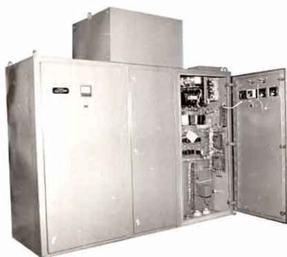
Для резинотехнической промышленности предназначено для обеспечения комплектного управления реверсивными электроприводами тяжелых механизмов. КРУ рассчитаны для работы в установках трехфазного переменного тока частотой 50 или 60 Гц в сетях с изолированной или подключенной через дугогасительный реактор нейтралью.
