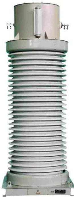
С обмоткой звеньевого типа, бумажно-масляной изоляцией предназначен для передачи сигнала измерительной информации приборам измерения, защиты, автоматики, сигнализации и управления в электрических цепях переменного тока частоты 50 или 60 Гц.
