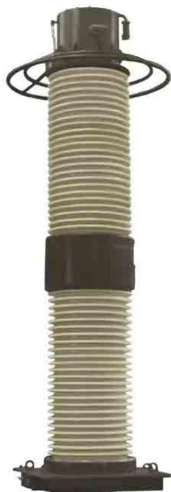
С обмоткой звеньевго типа, бумажно-масляной изоляцией предназначен для передачи сигнала измерительной информации приборам измерения, защиты, автоматики, сигнализации и управления в электрических цепях переменного тока частоты 50 или 60 Гц.
