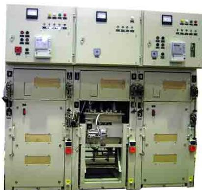
Предназначена для приема и распределения электрической энергии трехфазного переменного тока частоты 50 и 60 Гц напряжением 6-10 кВ в сетях с изолированной или заземленной через дугогасительный реактор нейтралью. Камеры КСО изготавливаются для поставок внутри страны и на экспорт.
